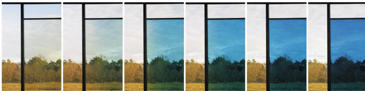
Rysunek 1. Elektrochromizm urządzenia typu smart windows zawierające tlenek wolframu(VI) oraz błękit pruski jako elektroaktywne materiały elektrochromowe oraz jonoprzewodzący elektrolit polimerowy PVB.[65]
