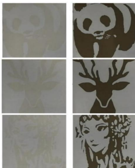
Rysunek 3. Zmiany redoks warstwy Li-NiO w stanie zredukowanym (po lewej) i utlenionym (po prawej).[74]
