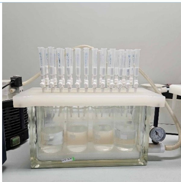
Rysunek 15. Typowy aparat stosowany podczas ekstrakcji do fazy stałej
