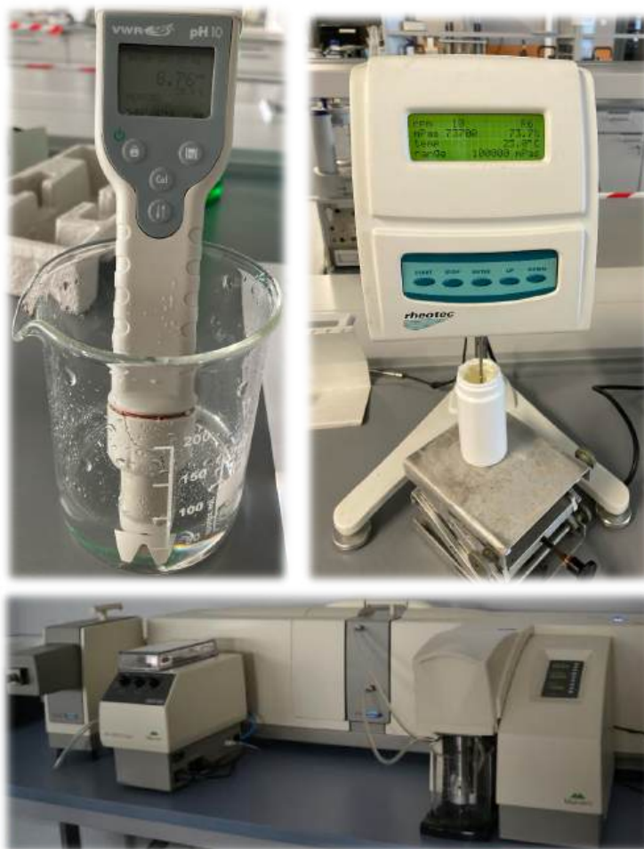
Rys. 6.5. Aparatura stosowana do oceny pH (EcoSense® pH 10 pH/Temperature Meter, Pen Style (firmy VMR International)), lepkości rotacyjnej (wiskozymetr RC02 firmy Rheotec) i rozkładu wielkości cząstek (Mastersizer 2000, firmy Malvern Instruments Ltd)
