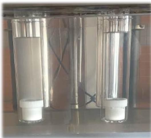
Rys. 6.7. Teflonowe komory ekstrakcyjne w trakcie badania w aparacie łopatkowym Varian Vankel 7010. (firmy Agilent Technologies).
