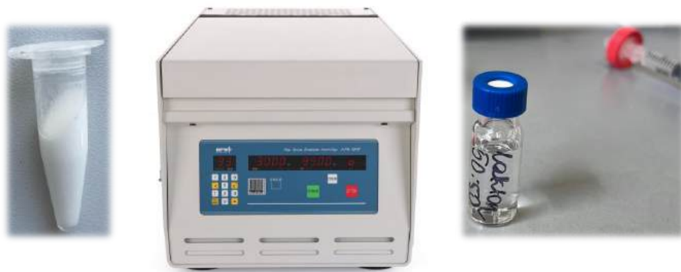
Rys. 6.4. Probówka Eppendorf Tubes® z uzyskaną dyspersją, wirówka laboratoryjna MPW-350R (firmy MPW Med. Instruments) oraz roztwór poddawany analizie HPLC po przesączeniu przez filtr strzykawkowy o średnicy porów 0,45 \mu\text{m} .
