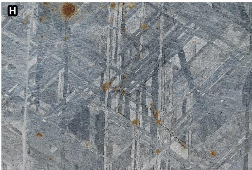
Ryc. 7 Meteoryt żelazny Muonionalusta – oktaedryt drobnoziarnisty (IVA) z widocznymi figurami Widmanstättena.
