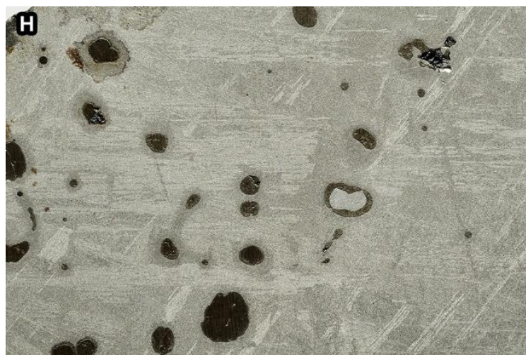
Ryc. 9 Meteoryt żelazny Gebel Kamil – ataksyt (meteoryty żelazne niezgrupowane) z widocznymi inkluzjami troilitu, schreibersytu oraz cohenitu.
