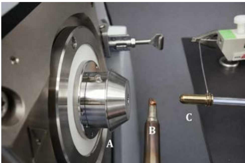
Rysunek 10. Aparatura stosowana w technice FAPA-MS: (A) wlot spektrometru mas, (B) układ grzewczy z tygłem, (C) źródło jonów FAPA.
