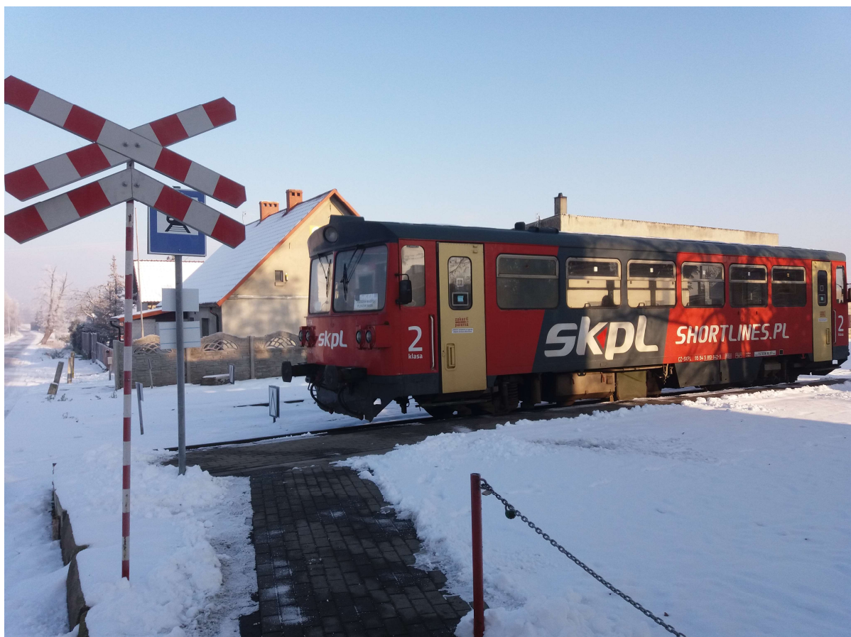
Fot. 3. Czeski wagon motorowy serii 810 należący do SKPL Cargo sp. z o. o. przewozi pasażerów po trójszynowym odcinku Pleszewskiej Kolei Lokalnej, zapewniając dowóz ze stacji normalnotorowej Pleszew (położonej we wsi Kowalew) do centrum miasta.
