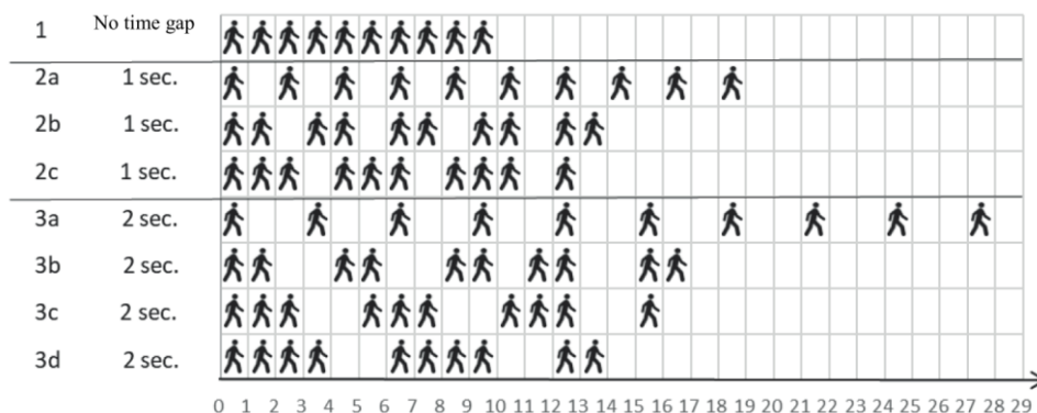
Ryc. 6. Scenariusz kalibracji czujnika pyro-elektrycznego
