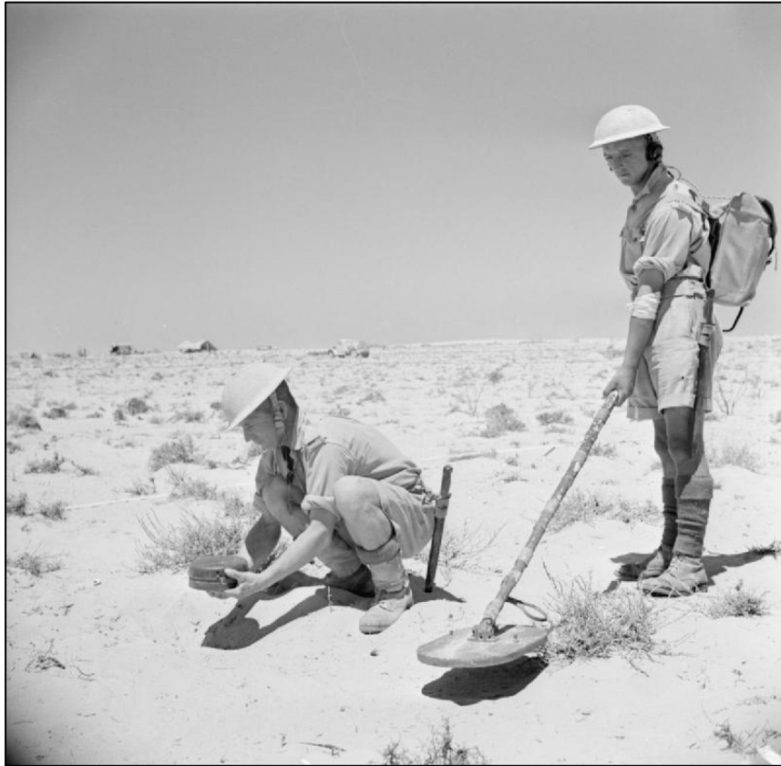
Ryc. 2. Brytyjscy saperzy rozminowują pustynię w okolicach El Alamein w sierpniu 1942 r. przy pomocy wykrywacza min Mark 1 (fot. Imperial War Museum, Londyn).
