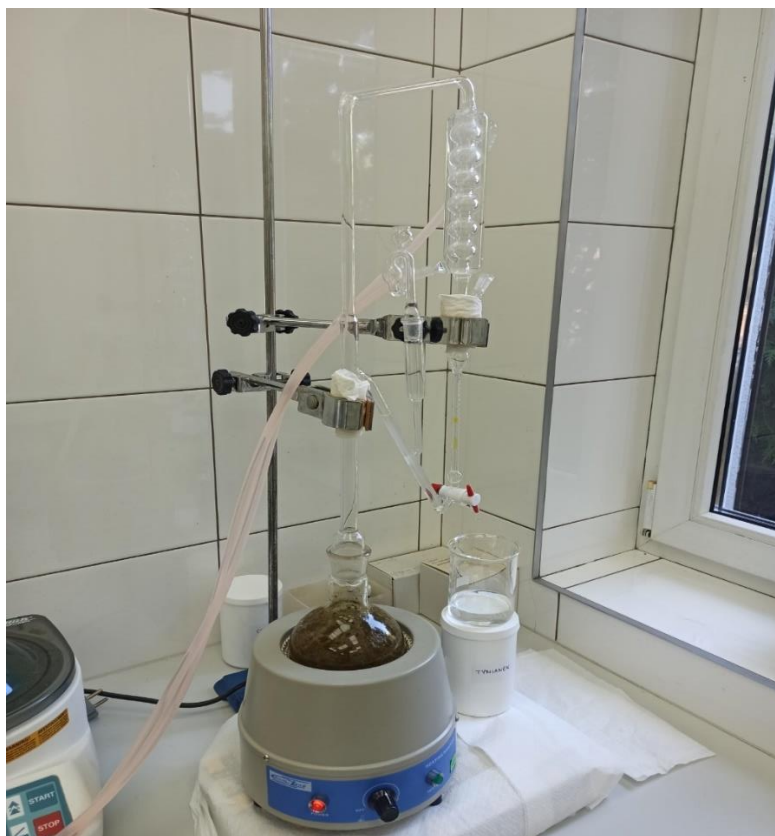
Zdj. 25. Aparat Clevengera w trakcie procesu destylacji olejku z tymianku
