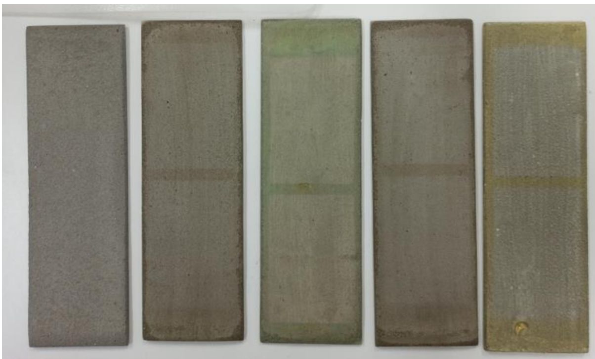
Zdj. 23. Płytki po teście w komorze starzeniowej (pierwsza kontrola bez powłoki, pozostałe próbki z powłoką)
