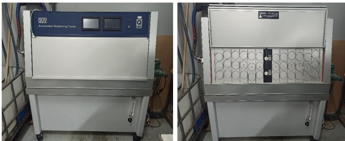
Zdj.22. Komora starzeniowa model Q-LAB: QUV/spray/RP (zamknięta i otwarta).
