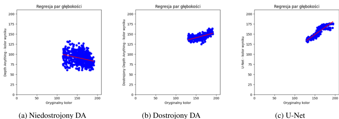
Fig. 4.6 Porównanie danych prawdziwych z wynikami modeli regresji dla map głębokości lizymetru. Panel (a) przedstawia wyniki dla niedostrojonej wersji Depth Anything, panel (b) dla dostrojonej wersji Depth Anything, a panel (c) dla modelu U-Net. Na niebiesko są oznaczone poszczególne wyniki, a na czerwono jest pokazana regresja liniowa. Zmiana w odległości tych punktów od linii regresji obrazuje poprawę dokładności wyliczania odległości do lizymetru. Również kierunek regresji liniowej jest istotny i przy idealnym wyniku powinien przebiegać pod kątem 45^\circ (wartość rzeczywista odpowiada wartości przewidzianej)
