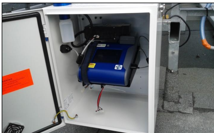
Rysunek 46. Aparatura pomiarowa stosowana na stanowisku badawczym - pyłomierz DustTrack DRX 8533
