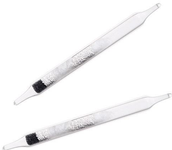
Rysunek 19. Rurka sorpcyjna (SKC) wypełniona złożem (żel krzemionkowy, węgiel aktywny, wata szklana) [164]
