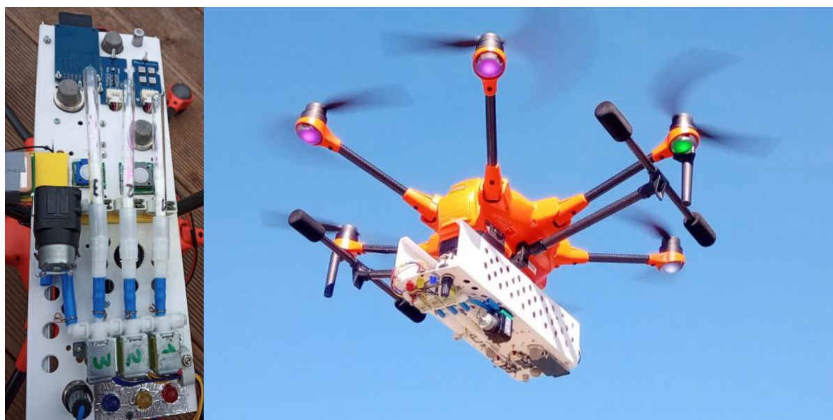
Rysunek 16. Zdjęcie poglądowe aparatury kontrolno-pomiarowej (widok od spodu oraz w trakcie lotu, sprzężonej z BSP)
