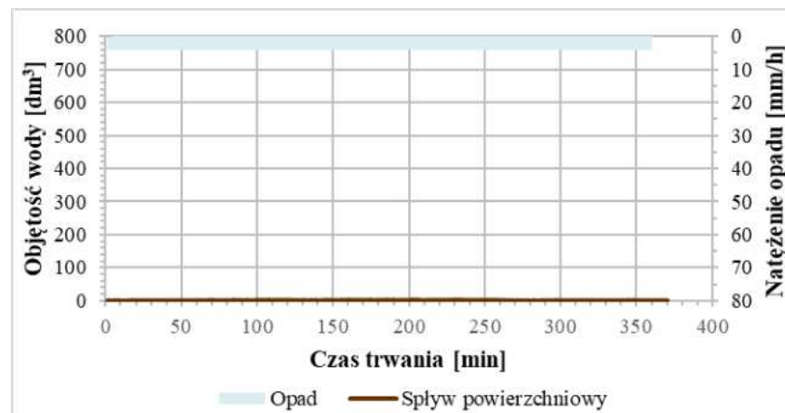
Z2. 30. Krzywa dynamiki splywu powierzchniowego na ugorze dla opadu A0 w warunkach wilgotnych (W)
