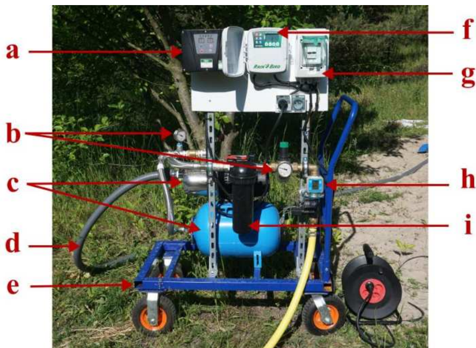
Ryc. 5.11. Zestaw pompowo-filtracyjny i pomiarowy ze sterowaniem (8.07.2022) a) falownik IMF, b) manometry i armatura połączeniowa, c) pompa ze zbiornikiem przeponowym, d) wąż ssawny, e) wózek transportowo-platformowy, f) sterownik czasowy i elektrozawór, g) szafa elektryczna z zabezpieczeniami, h) miernik przepływu wody, i) filtr dyskowy
