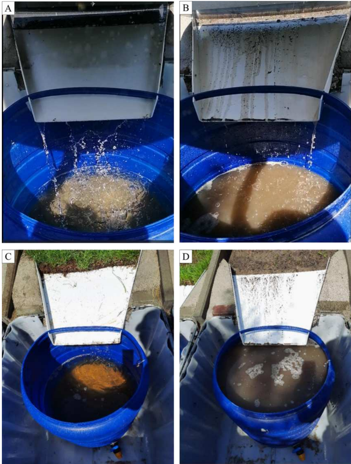
Ryc. 6.5. A) Spływ powierzchniowy po rynnie na poletku kostką podczas symulacji opadu B2 (18.07.2022); B) Spływ powierzchniowy po rynnie na poletku ugorze podczas symulacji opadu B2 (18.07.2022); C) Chwytnacz spływu powierzchniowego na trawie po symulacji opadu B2 (18.07.2022); D) Chwytnacz spływu powierzchniowego na ugorze po symulacji opadu B2 (18.07.2022)
