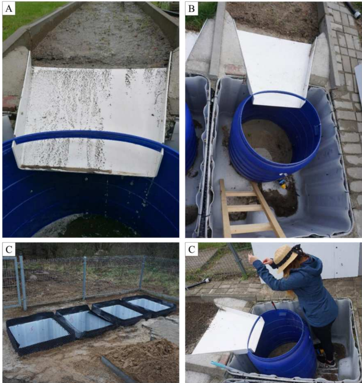
Ryc. 5.5. A) Rynna kierująca spływ do chwytacza spływu powierzchniowego (13.07.2022); B) Chwytacz spływu powierzchniowego (8.07.2022); C) Komory chwytaczy spływu powierzchniowego podczas montażu (20.11.2021); D) Montaż Levelloggera w chwytaczu spływu powierzchniowego (fot. M. Marciniak, 8.07.2022)
