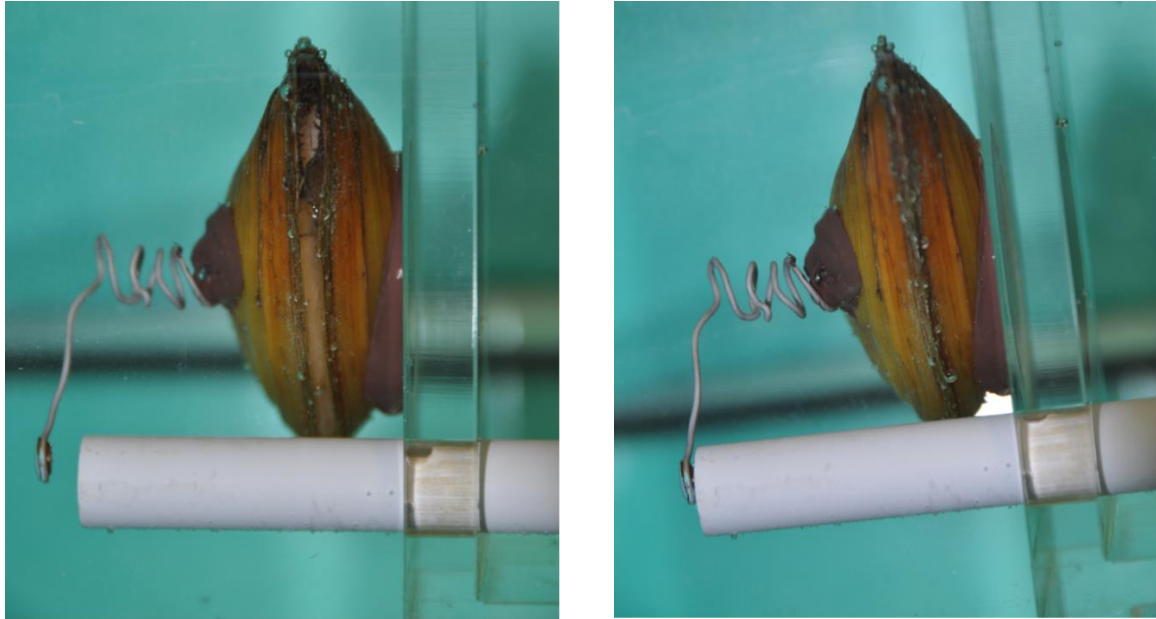
Rys. 3. Małż w trakcie kalibracji systemu. Widoczne maksymalne otwarcie i zamknięcie skorup.
