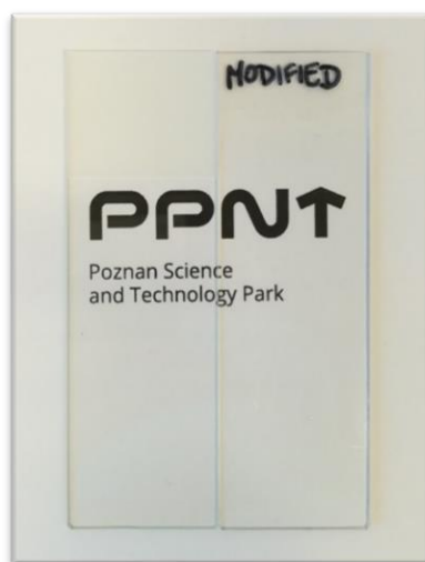
Rys. 16 Zdjęcie przedstawiające niemodyfikowaną płytkę szklaną (po lewej) i płytkę pokrytą powłoką P4 (po prawej)
