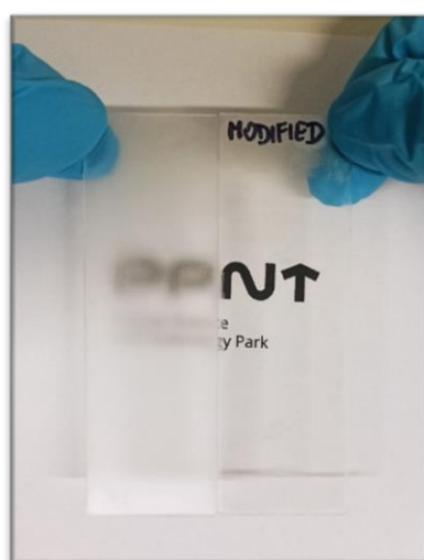
Rys. 25 Zdjęcie przedstawiające zachowanie się szklanych płytek po wyjęciu z zamrażarki ( -20^{\circ}\text{C} ) do temperatury pokojowej ( 22^{\circ}\text{C} ). Po lewej stronie próbka odniesienia, po prawej stronie płytka pokryta preparatem P4
