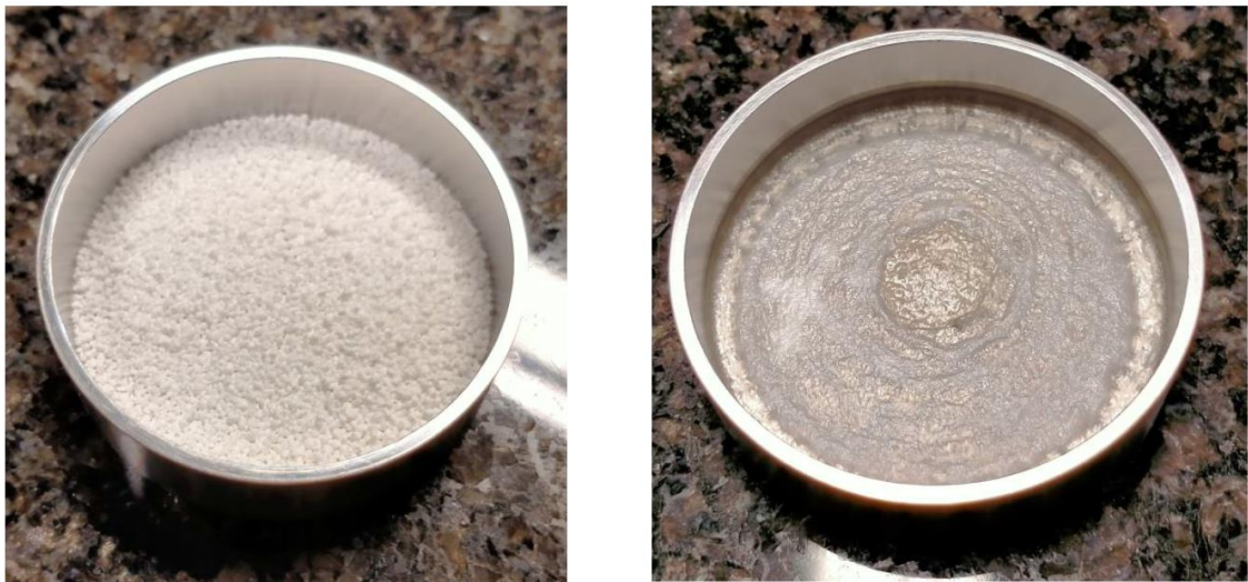
Rys. 47. Fotografie próbek nawozu Zn(II)IDHA z dodatkiem tensydów (frakcja 200-900 \mu\text{m} ) przed (po lewej) i po rejestracji izotermi adsorpcji wody (po prawej)
