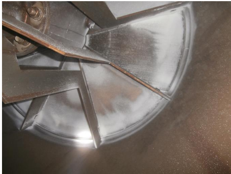
Rys. 23. Drobnny pył przedostający się pod dystrybutor gazu
