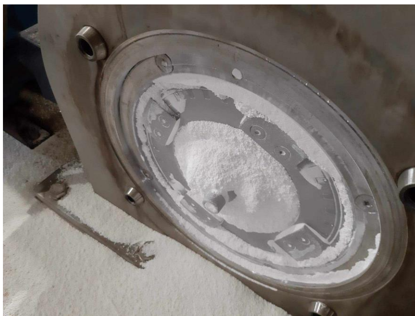
Rys. 35. Niedrożny młyn w wyniku niestabilności procesu i wzrostu strumienia mielonego materiału (powyżej 190 \text{ kg/h} )
