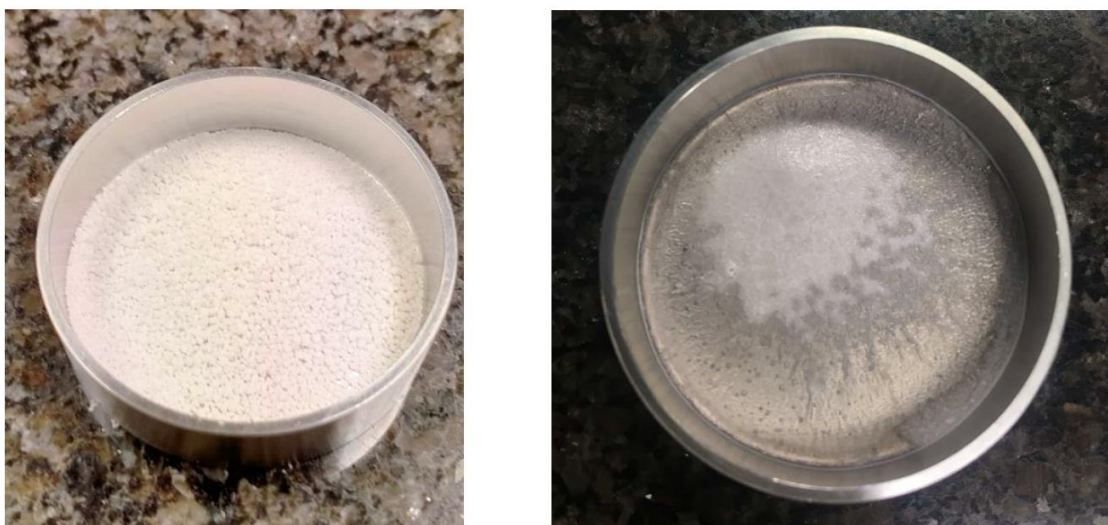
Rys. 43. Fotografie próbek nawozu mineralnego Zn(II)IDHA przed (po lewej) i po rejestracji izotermi adsorpcji wody (po prawej)
