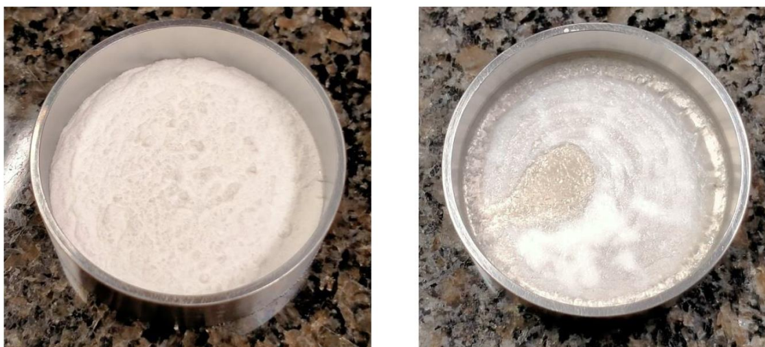
Rys. 49. Fotografie próbek frakcji pylistej (<200 \mu\text{m} ) Zn(II)IDHA z dodatkiem tensydów przed (po lewej) i po rejestracji izotermy adsorpcji wody (po prawej)
