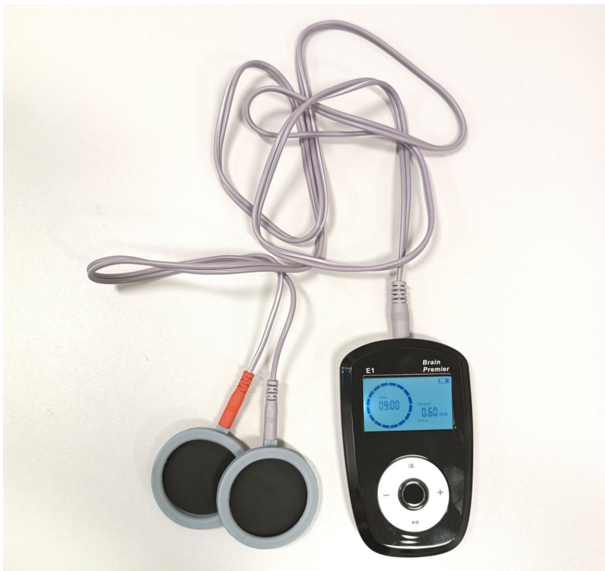
Rycina 43. Urządzenie do przeczaszkowej stymulacji prądem stałym. Certyfikowane urządzenie Brain Premier E1 (Caputron) składa się ze stymulatora prądu, który umożliwia ustawienie czasu stymulacji i natężenia prądu oraz dwóch okrągłych elektrod o powierzchni 12,57 cm 2 (średnica – 1,5 cala) połączonych ze stymulatorem przez przewody.
