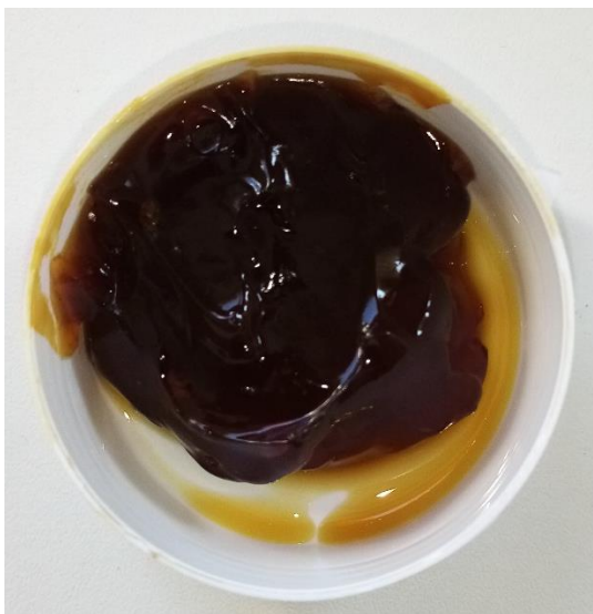
Rysunek 10. Próbką zawierająca organożel krzemionkowy z ekstraktem z propolisu – posiadająca widoczne objawy synerезy.
