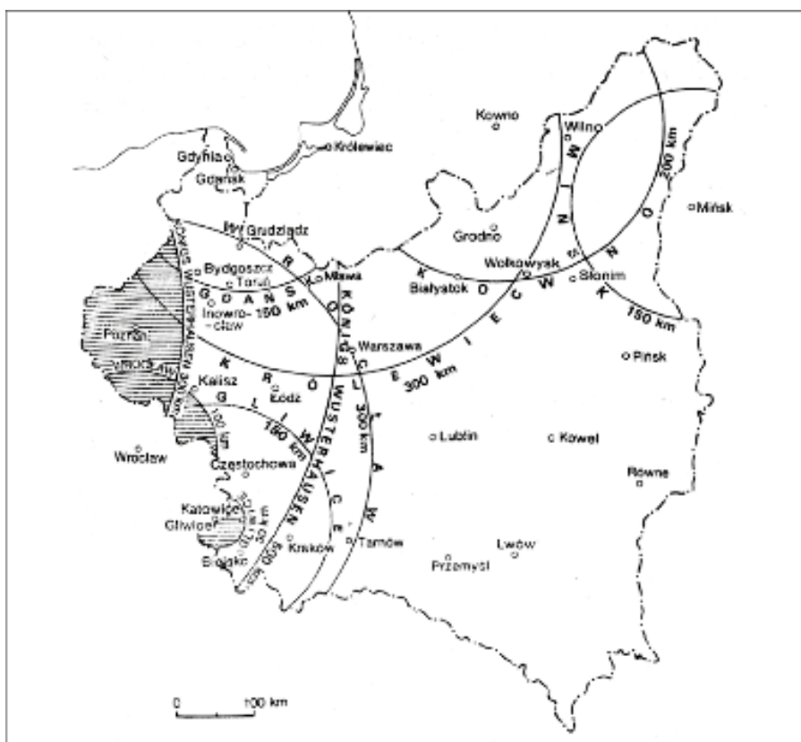
Mapa 3.1. Zasięg radiostacji niemieckich w 1926 roku, z podziałem na zasięg odbiorników jednolampowych (obszar zakreskowany) oraz zasięg odbiorników detektorowych
